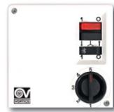
**SCRR5L:** 5-Stufen-Trafo zur brummfreien Regelung von Nicht-ECO Deckenventilatoren. Mit beleuchtetem Ein-/Aus-schalter, zusätzlichem Licht- und Reversierungsschalter. Alle Trafos arbeiten mit einem gewickelten Kupfertransformator. Unterputz-Installation im speziellen UP-Gehäuse (**SCB5, Art.-Nr. 22483**) möglich. Motorleistung bis 100 Watt.
