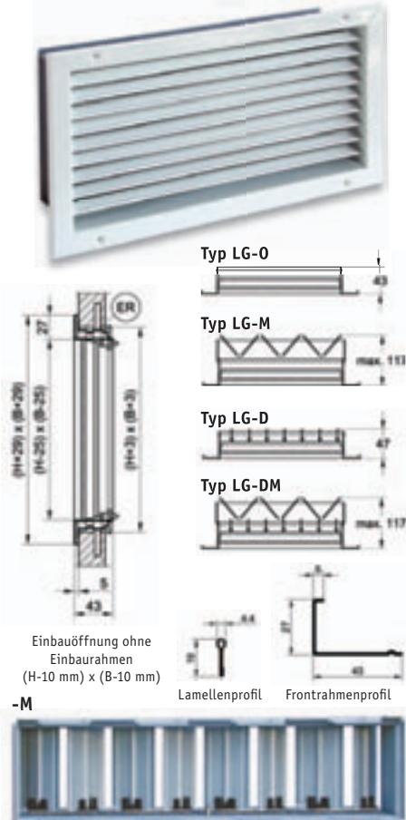
Mengeneinstellung aus profiliertem, matt verzinktem Stahlblech, Lamellen gegenläufig und gemeinsam verstellbar. Teilung 50 mm, Freier Querschnitt 5 - 95%.
